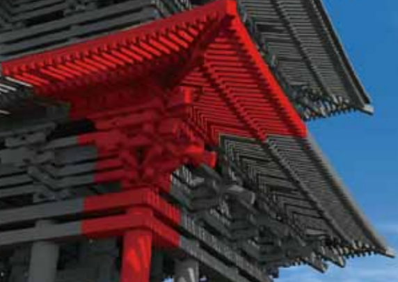
右は五重塔の全体3Dモデル。点線で囲った1階屋根根隅部(左図の赤色部分)をロボット棟梁で試作した。
