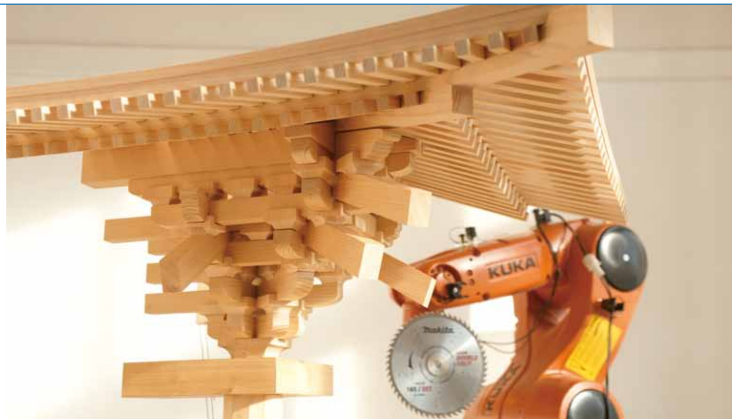
法華経寺五重塔屋根隅部の模型(1/5縮尺)と、ロボット棟梁。ロボット棟梁を大型のものに置き換えることで実物大での加工が可能になる。
