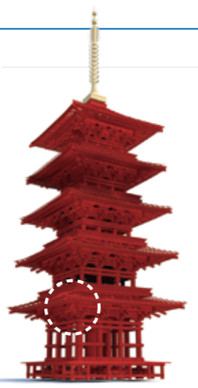
右は五重塔の全体3Dモデル。点線で囲った1階屋根根隅部(左図の赤色部分)をロボット棟梁で試作した。
