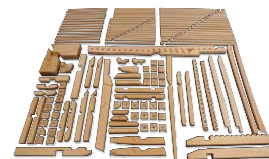
上/ロボット棟梁の部材加工の様子。ロボットに持たせるツール(丸ノコ、角ノミ、振動ノミ、ルータ)はオリジナル開発した。下/ロボット棟梁が切り出した五重塔1階屋根隅部の部材、全160パーツ。伝統木造建築特有の複雑な形状を忠実に再現。
